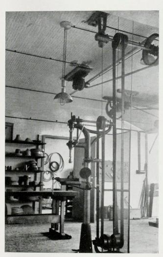
**abb. 60** bauhausgebäude metallwerkstatt, bohrmaschine
