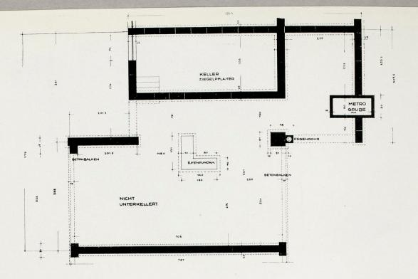
**abb. 150** siedlung dessau-törten keller- und fundamentgrundriß des typs 1927
