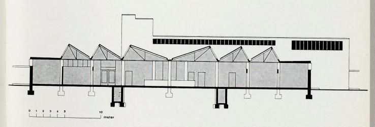
abb. 194 arbeitsamt dessau ost-west-schnitt durch den shedbau
