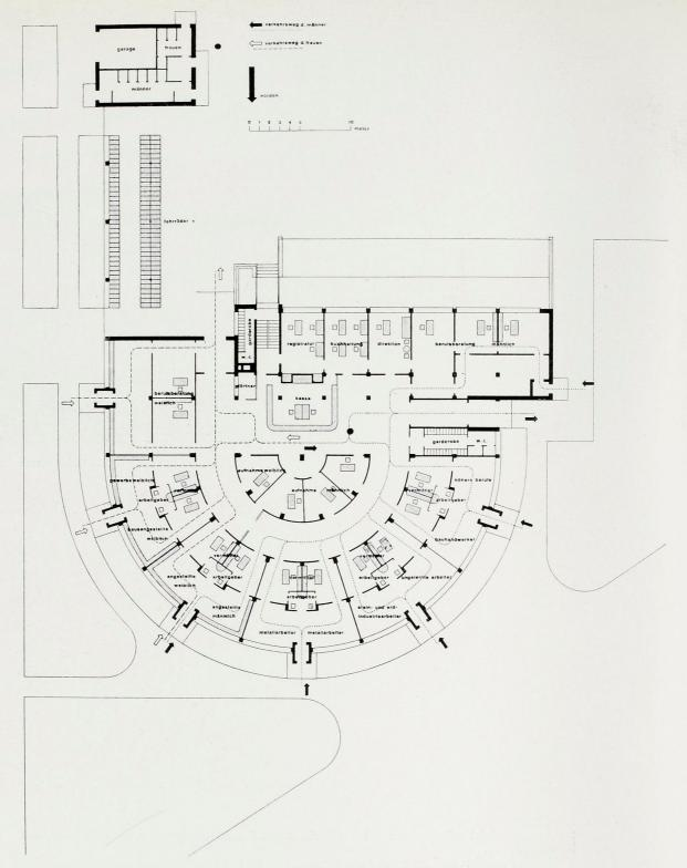
abb. 188 arbeitsamt dessau erdgeschoßgrundriß anordnung der hauptanlage zu ebener erde zur vermeidung von stauungen auf treppen
