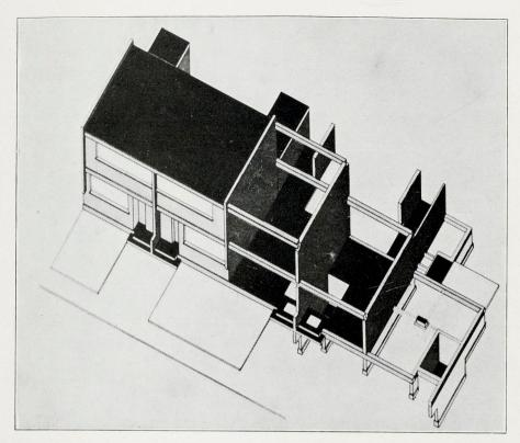
**abb. 144** siedlung dessau-törten konstruktionsschema baujahr 1926
