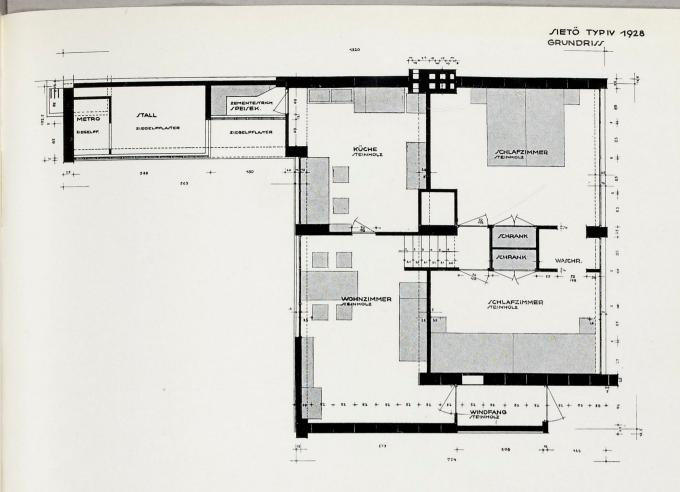
abb. 154 siedlung dessau-törten erd- und obergeschoßgrundriß des typs 1928
