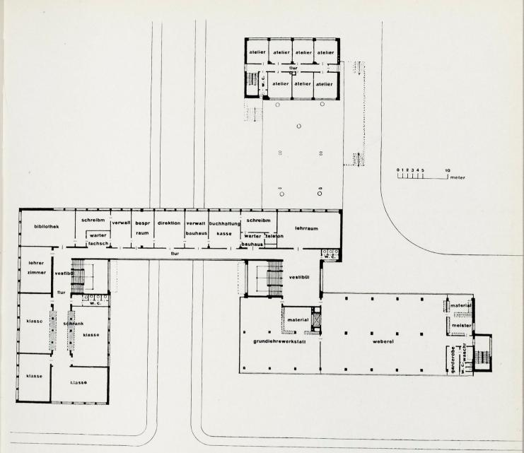
abb. 6 bauhausgebäude grundriß des 1. stockes
