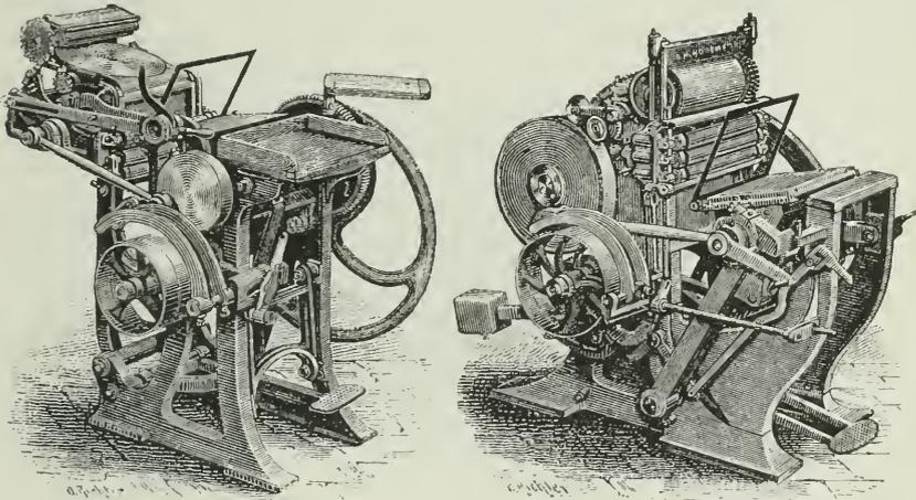
Nr. 251. Tiegeldruckpresse mit Tischfärbung    Nr. 252. Tiegeldruckpresse mit Cylinderfärbung
