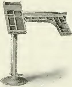
Nr. 225. Schiff der KASTENBEINschen Setzmaschine. (Nach dem Journal für Buchdruckerkunst.)
