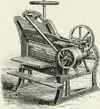
Nr. 270. Papierscheidemaschine für Dampftrieb
